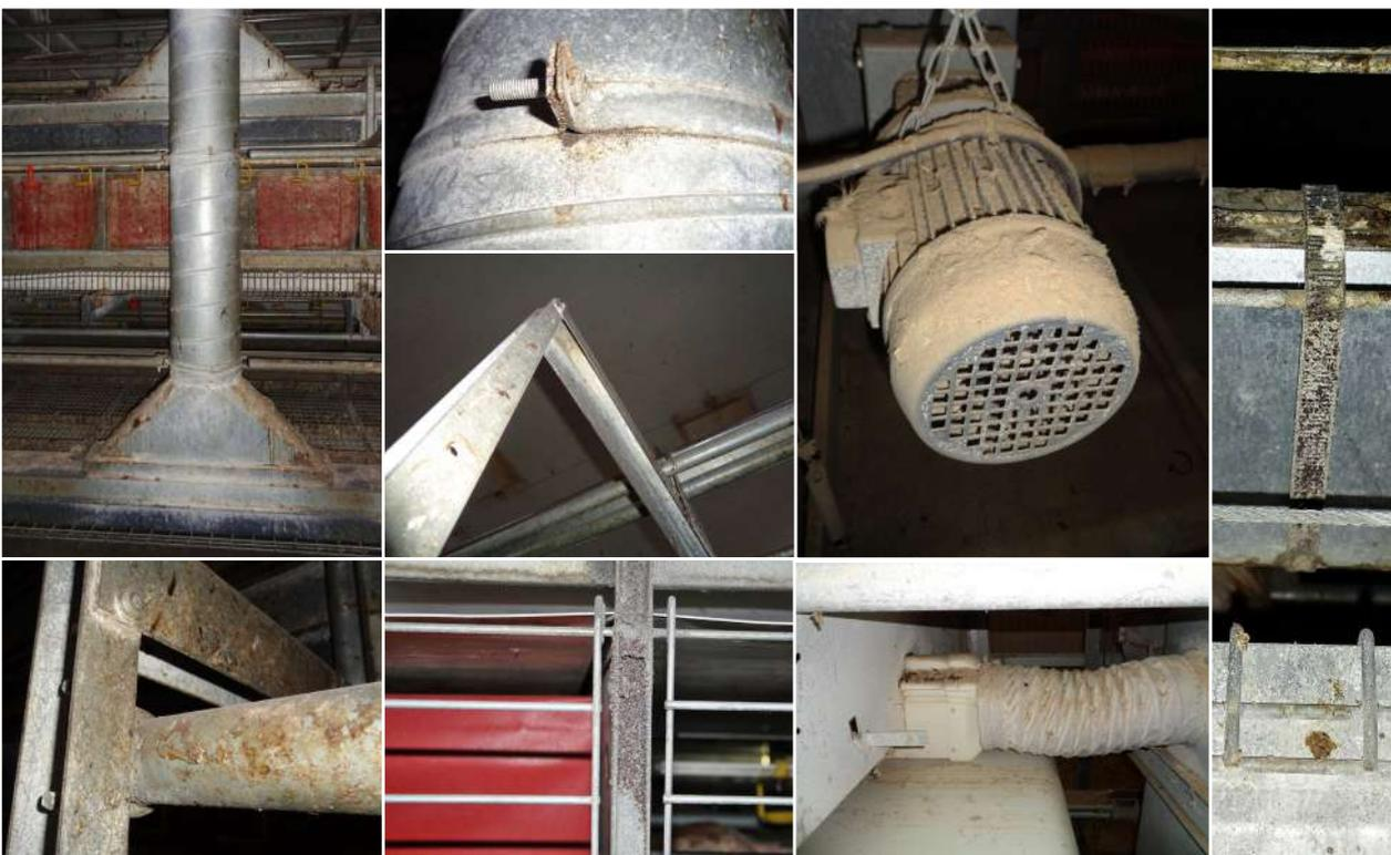
Figure 4 : Exemples de zones nécessitant un nettoyage en profondeur, tels que le système d'aération des tapis à fientes, les moteurs, les tubes, les joints, les structures de support, les attaches de câble
